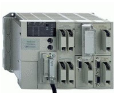
Рис. 5.2. Внешний вид ПЛК Modicon TSX Micro.
